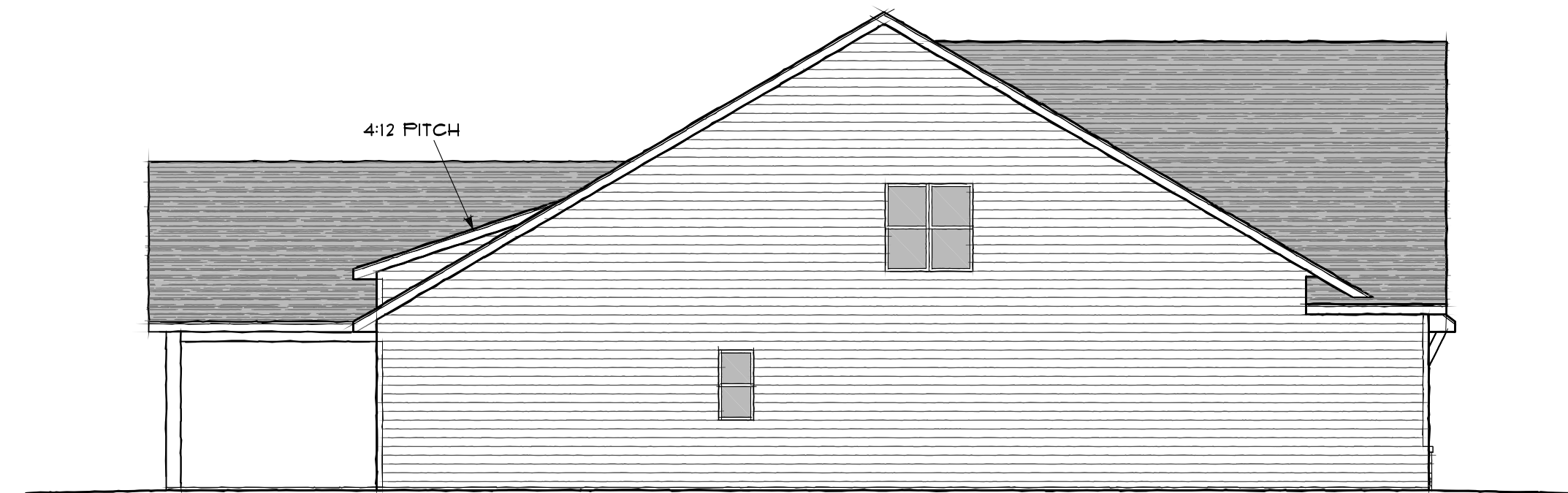
LEFT SIDE ELEVATION SCALE: 1/8" = 1'-0"
